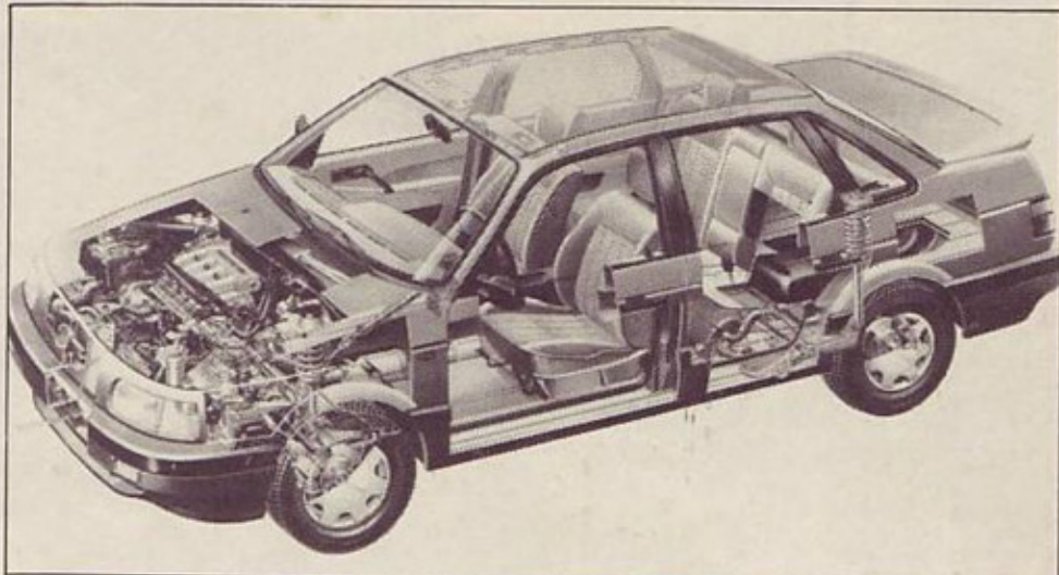
Novi VW passat (na risbi kot limuzina): prečno nameščen motor, izredna notranja dolžina, štirinajstcolsko kolesa, skrbno nadzorovana kinematika pri obeh premah, 70-litrsko posoda za gorivo in zasilno rezervno kolo v zadku. Za doplačilo (med drugim): po višini nastavljiv volan in ABS
