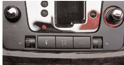
Podvozje: nastavljamo lahko trdoto (levi gumb) in višino (desni gumb).
