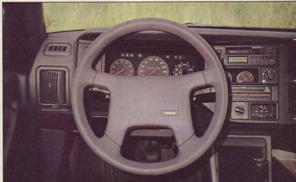
*Armatura plošča je optimalno pregledna z merilnikom hitrosti v sredini*
