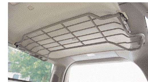
Uporabno! Kovinsko pregradno mrežo so inženirji pospravili kar pod strop prtljavnika.
