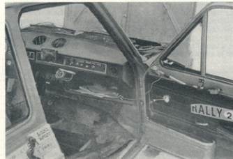
Rezervirano za sovoznika: dodatna stikala in lučke, merilnik temperature hladilne tekočine in luč z gibljivim vratom za branje kart
