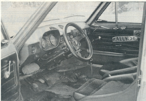
Voznikov delovni prostor: oprijemljiv sedež in premajhen obroč volana. Vse drugo je kot v običajnih »stoenkah«, na sliki manjka le merilnik vrtiljavov motorja
