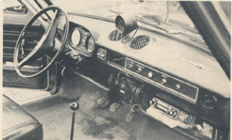
Stikala pred sovoznikom ravnajo pomožni kontakti in vžig ter dodatne žaromete
