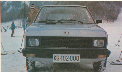
Čista oblika, gladke površine. Odbijača sta iz ojačane plastike. Brisalnika, vzvratno ogledalo in kljuko na vratih so stari znanci s stoenke
